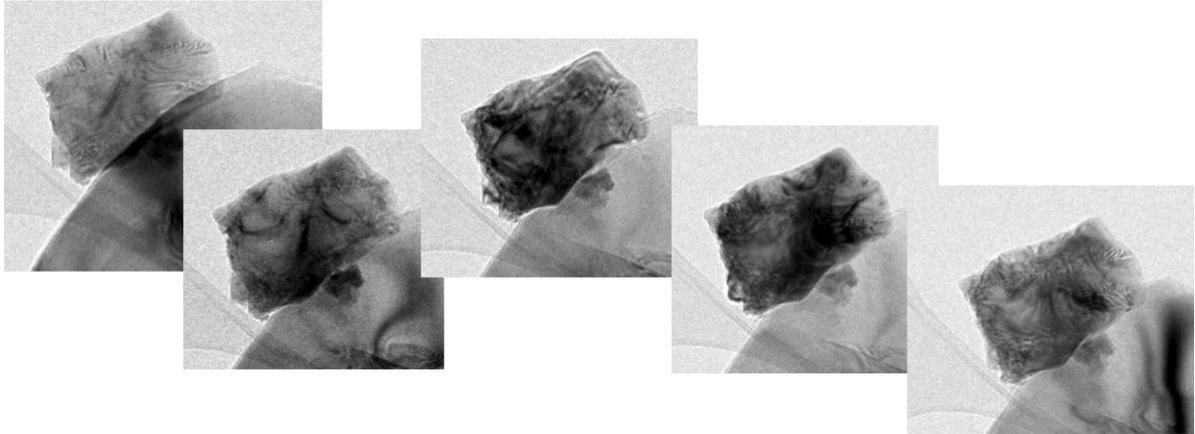
Fig.26 Cristal de SiC con dos grados de diferencia de inclinación entre imágenes consecutivas.
