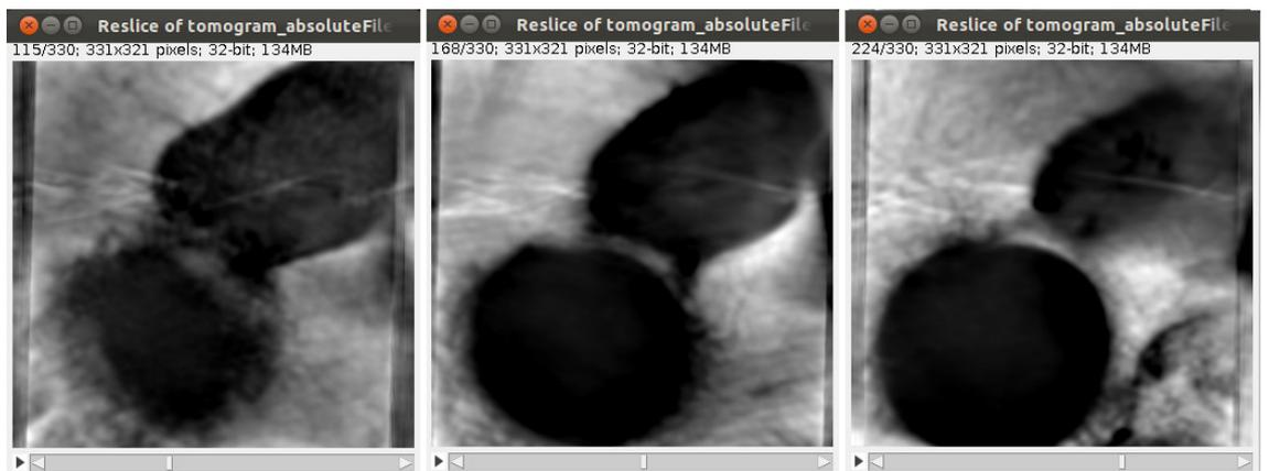
**Figura 4.4.2** Reconstrucción obtenida a partir de la serie alineada con el algoritmo *SIRT* de Tomo3D
